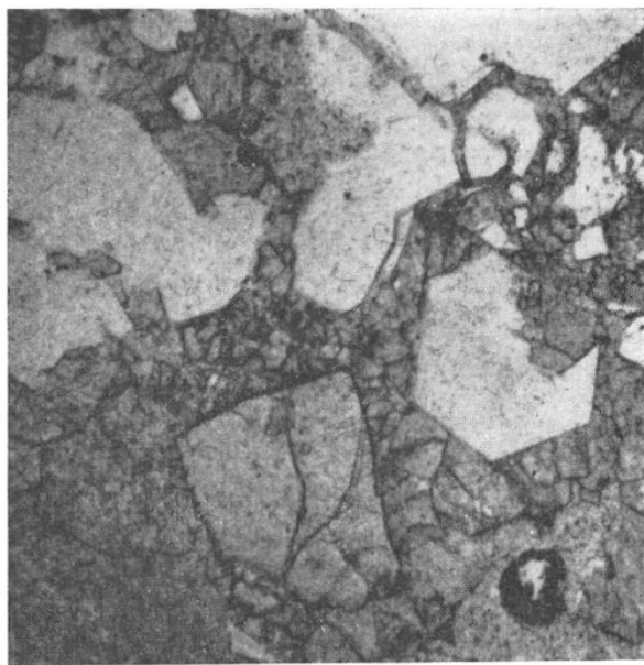
FIG. 1. — Lame mince dans un calcaire cristallin récolté Gare d'Austerlitz (Lut. sup., Marnes et Caillasses. G = \times 50 ).
