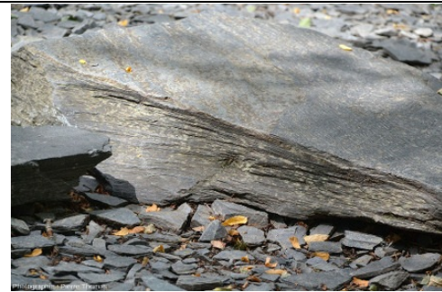
Figure 26. Gros bloc d'ardoise (les feuilles mortes donnent l'échelle) près de l'atelier moderne de taille, attendant d'être clivé et taillé par l'ardoisier
