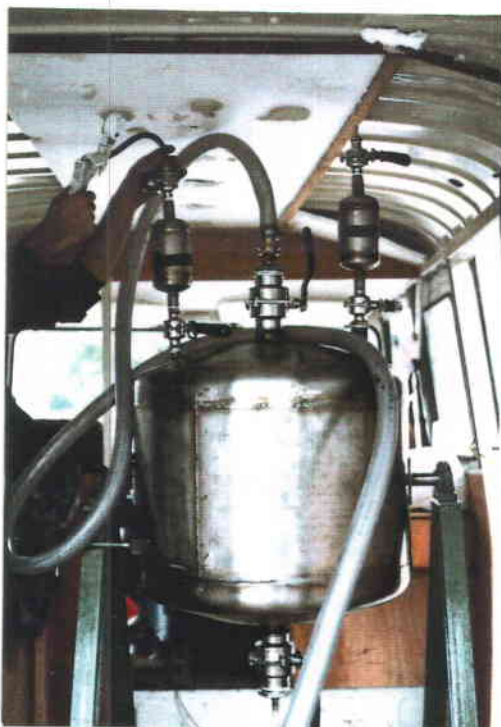
Photo 2.1 - Cuve en inox pour le prélèvement du fluide sous pression, en vue de son analyse pour le carbone 14. Les réactifs sont ajoutés pour le biais des ampoules placées sur la partie supérieure.
