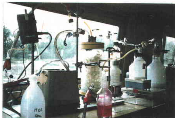
Photo 2.2 - Extraction du \text{CO}_2 dissous pour analyse du fluide en ^{14}\text{C} (Chelles, mai 1988)
