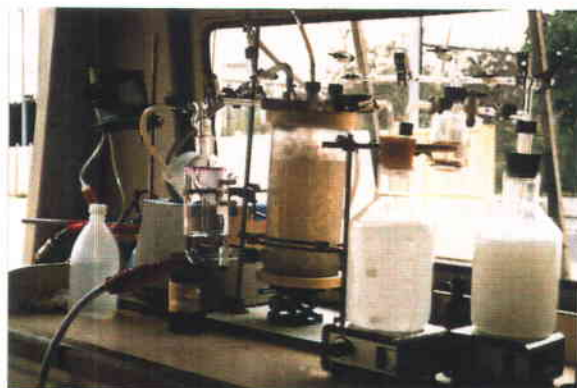
Photo 2.3 - Extraction du \text{CO}_2 dissous pour analyse du fluide en ^{14}\text{C} (Maisons Alfort, mai 1988)
