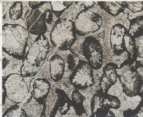
Fig. 3-6. – Minerai oolithique vu au microscope en lumière naturelle. Les oolithes sont constituées à 80 % de sidérite, 20 % de chlorite, dans une matrice de sidérite avec de la matière organique en abondance (graphite et graphitoïdes). Quelques nuclei correspondent à du zircon détritique et de l'apatite strontifère. La bordure noire autour des oolithes est constituée de marcassite et pyrite.
